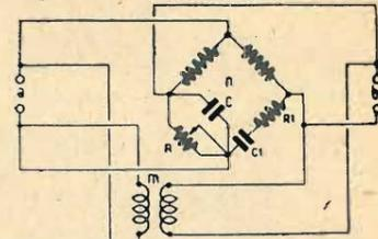
Fig. 2 (Cons. G. Ter. 6732). Accordo a variazione di resistenza con uso contemporaneo di reazioni positive e negative: a) e b) entrata e uscita della catena di amplificatori aperiodici; m) circuito di reazione positiva; p) circuito di controreazione; R = resistore di accordo.
