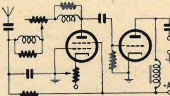
Fig. 1b (Cons. G. Ter. 6732). Accordo per variazione di resistenza con connessione a « dynatron ».
