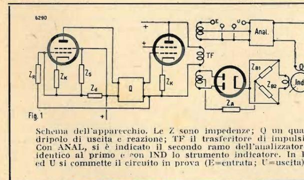
Schema dell'apparecchio. Le Z sono impedenze; Q un quadrupolo di uscita e reazione; TF il trasformatore di impulsi. Con ANAL, si è indicato il secondo ramo dell'analizzatore identico al primo e con IND lo strumento indicatore. In E ed U si commette il circuito in prova (E=entrata; U=uscita).
