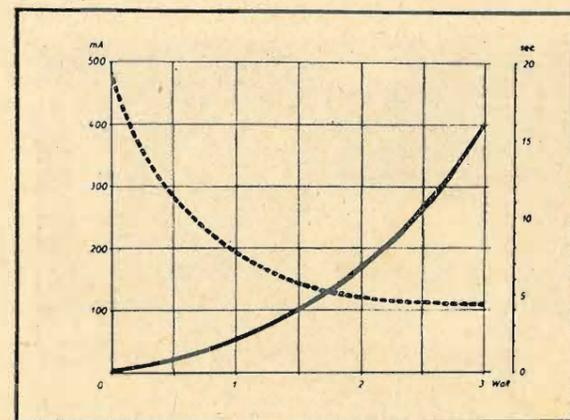
Fig. 1. - Caratteristiche dei termistori capillari per la costruzione di apparecchi radio.
