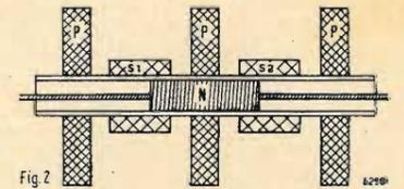
Il trasformatore di impulsi. Con P si sono indicate le tre sezioni primarie; con S le due secondarie; con N il nucleo mobile in poliferro.
